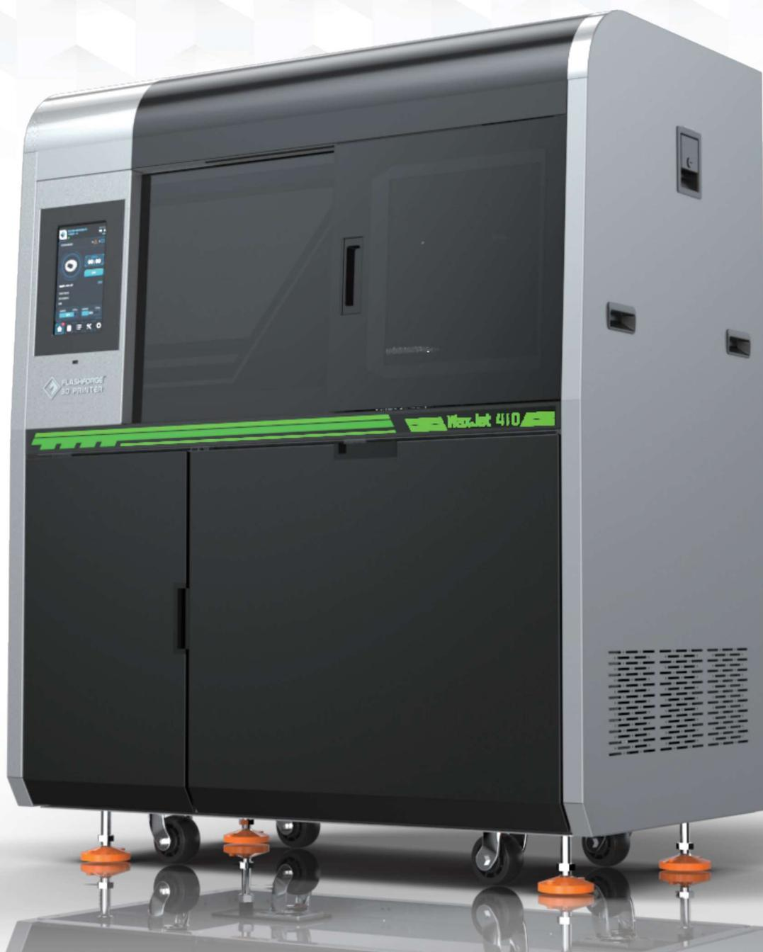
La stampante 3D WaxJet 410 adotta la tecnologia di stampa mutijet per la realizzazione modelli in cera con superfici lisce per colate ad alta precisione. Il grande formato di stampa permette di posizionare più modelli, anche sovrapposti fra loro, lo spessore di ogni strato è di 0,016 mm. È adatto per gioielleria, orologi, componenti meccanici di precisione e aerospaziale.
